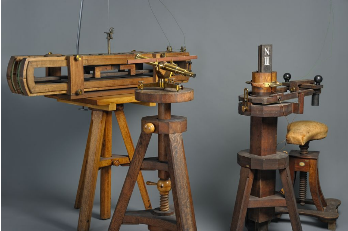
Abbildung 1: Der Gauß-Weber-Telegraf im Physikalischen Museum. Dieses Modell ließ Weber zwischen 1848 und 1873 anfertigen.
